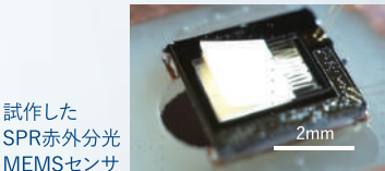
試作したSPR赤外分光MEMSセンサ 電気通信大学大学院 情報理工学研究所 機械知能システム学専攻 大下 雅昭、安永 竣
